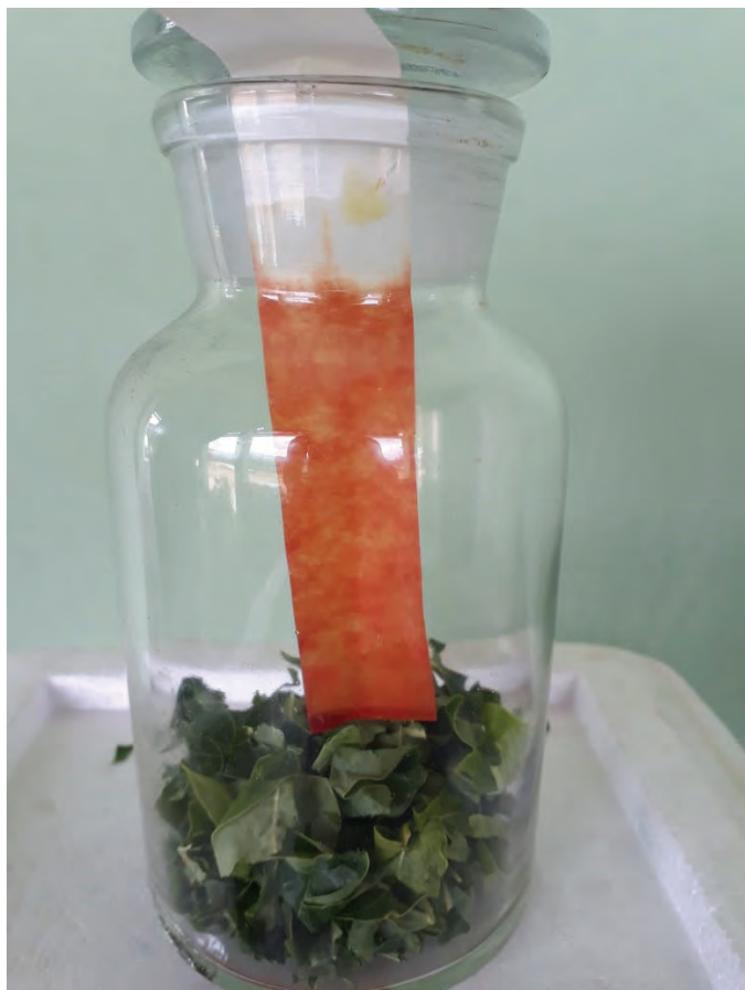
Fig.2. Teste de Guignard (papel picro-sódico). Reação positiva em 5 minutos para ácido cianídrico (HCN) nas folhas de Manihot sp.
